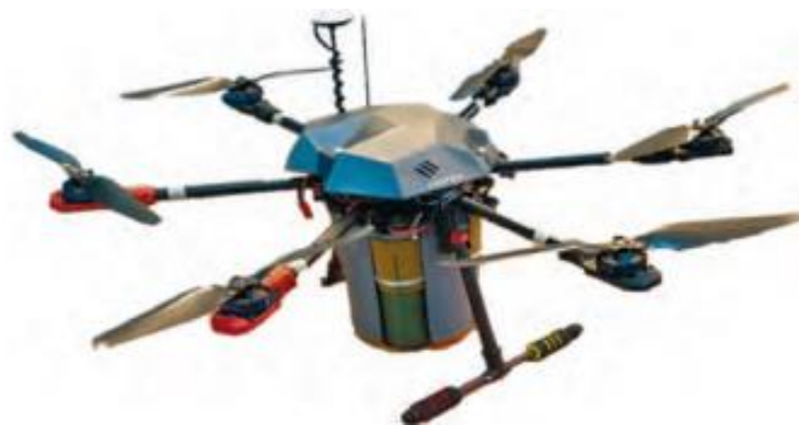
Рис. 2. Минный контейнер револьверного типа, установленный на гексакоптере
