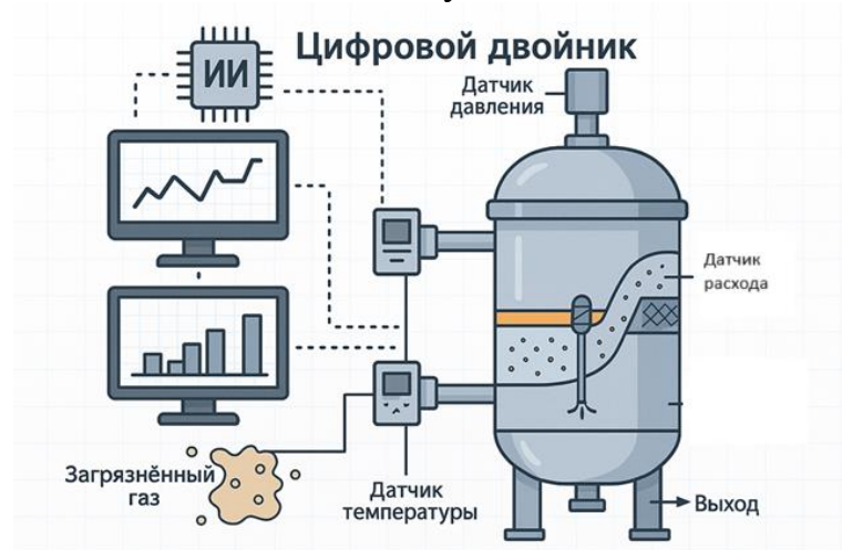
Рисунок 1. Визуализация цифрового двойника системы фильтрации.
