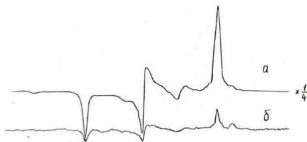
Рисунок 1. Спектры ЭПР Т-центра для двух типов кварцевых кристаллов, выращенных на нейтронно-облучённых затравках: (а) окрашивающиеся кристаллы, (б) неокрашивающиеся кристаллы
