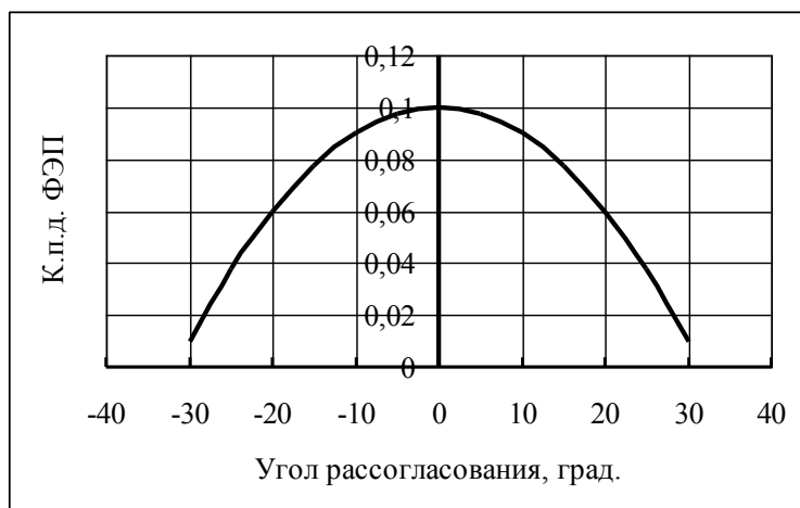
Рисунок 1. Зависимость к.п.д. ФЭП от угла рассогласования параболоцилиндрического концентратора
